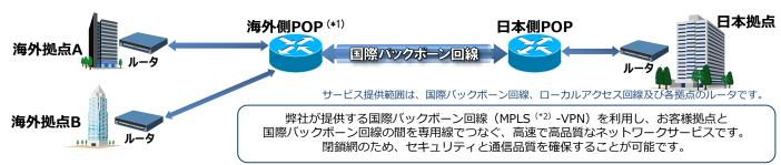
(\*1) MPLS (Multi-Protocol Label Switching) : ラベルと呼ばれる識別子を付加してデータ転送を行うことにより、通信の高速化や機能の付加を図る技術 (\*2) POP・Point Of Presence の略
